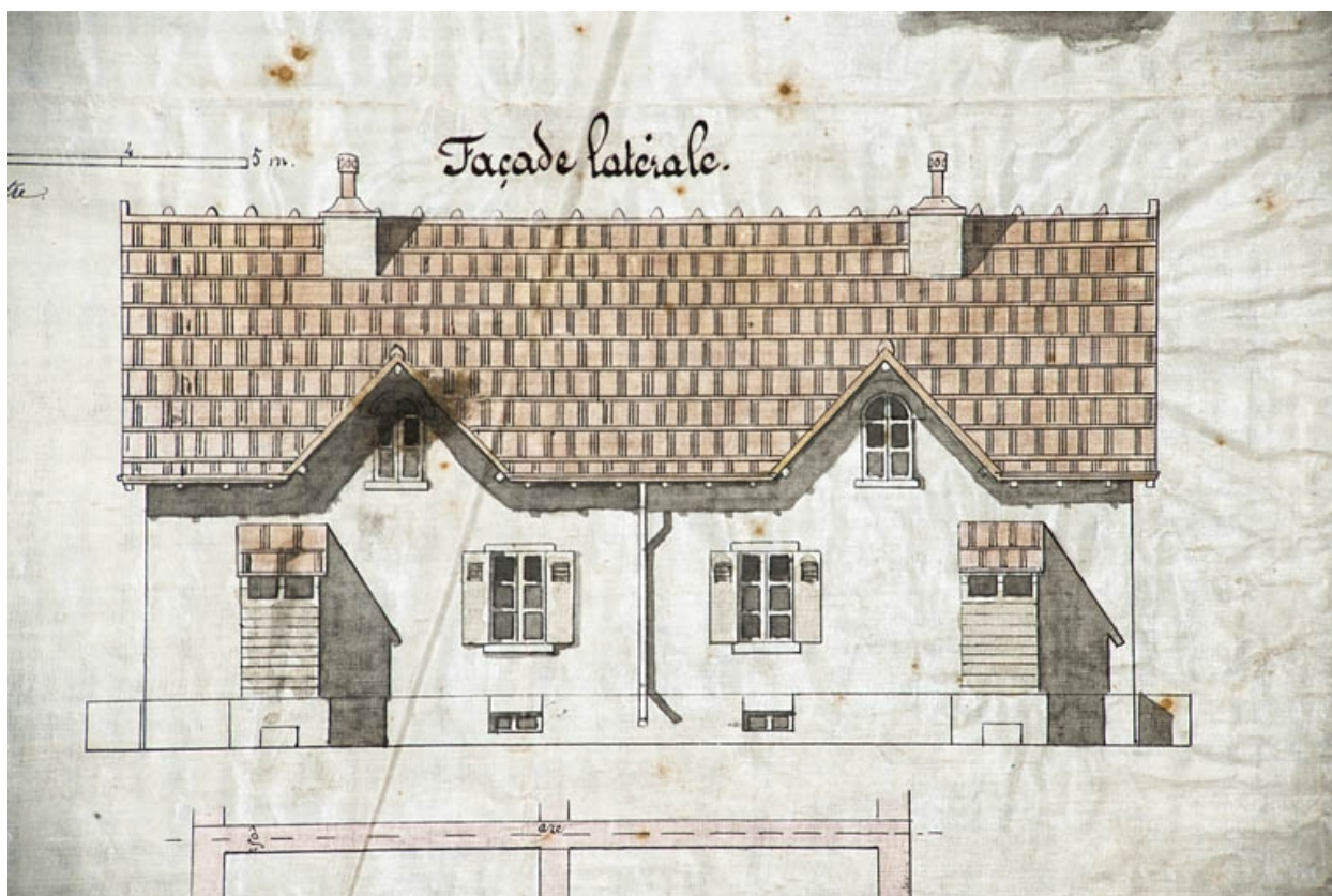
Cité Constant Peugeot et Cie. Maison à quatre logements. Façade latérale. Plans, coupes, élévations, toile, lavis, échelles 1/50 et 1/100, s.d. [1870].
