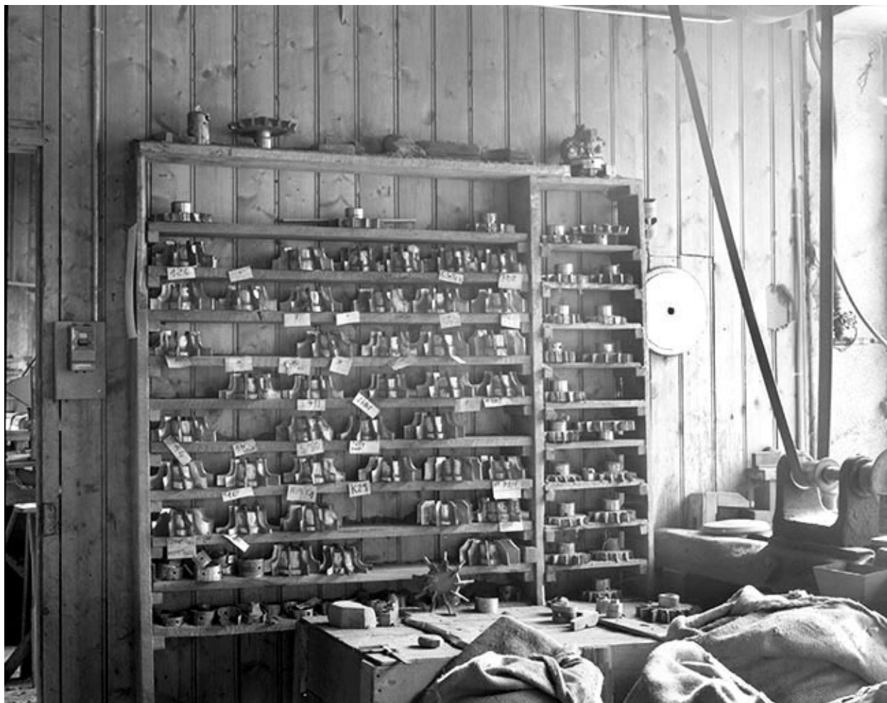
Atelier de mécanique : fraises pour l'ébauchage.
