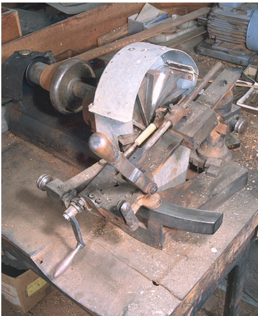
Vue de la pièce à usiner au contact des ciseaux de la fraise.
