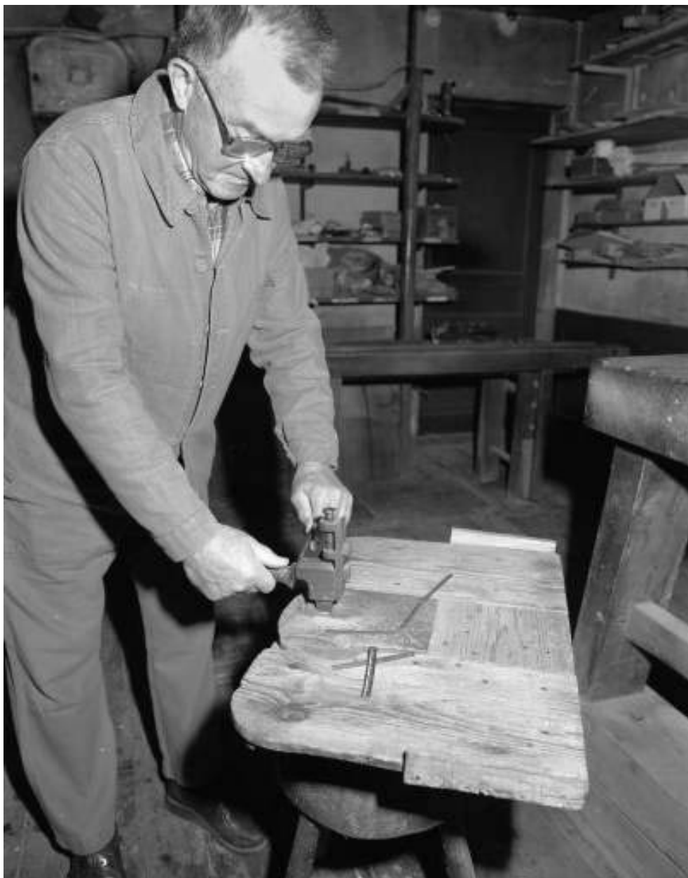
Mise au gabarit du "clou".
