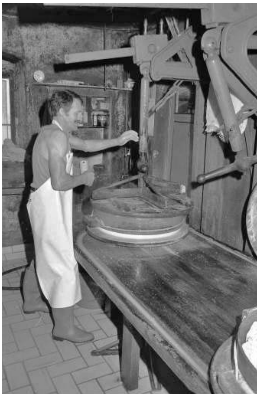
Fabrication du comté : serrage de la presse.
