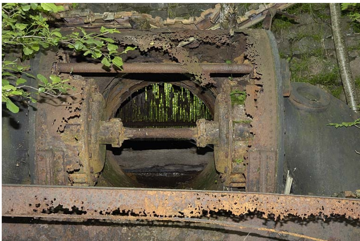
Turbine hydraulique à axe horizontal. Détail (les aubes ont disparu).
