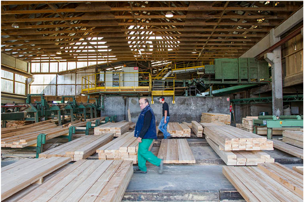
Atelier de triage et d'empilage (E) : intérieur. Au fond en hauteur, l'installation de sciage.
