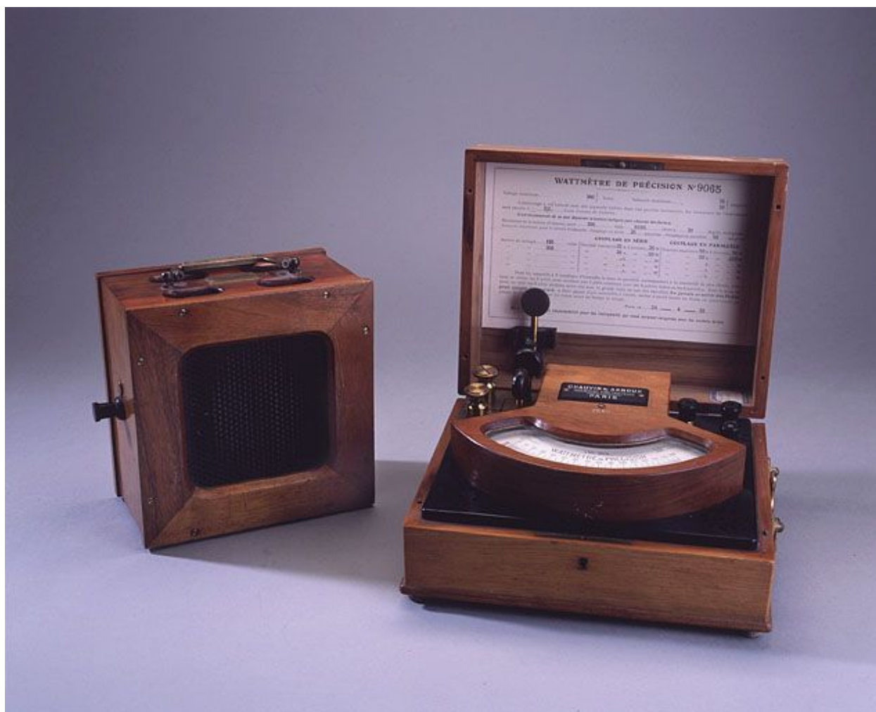
Vue d'ensemble du wattmètre et de son rhéostat.
