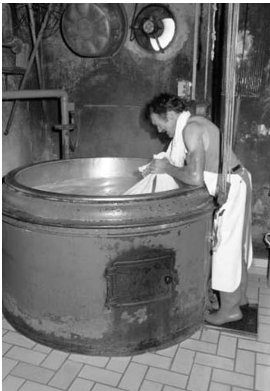
Fabrication du comté : fermeture de la toile.
