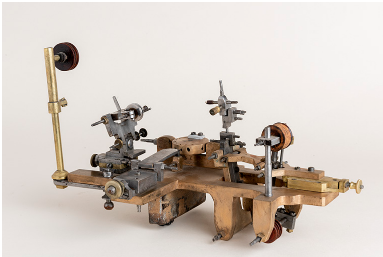
Machine à meuler et limer ("machine à passer les levées" pour la fabrication de l'échappement à cylindre), par Léon Girardin au Russey, 4e quart 19e siècle.
