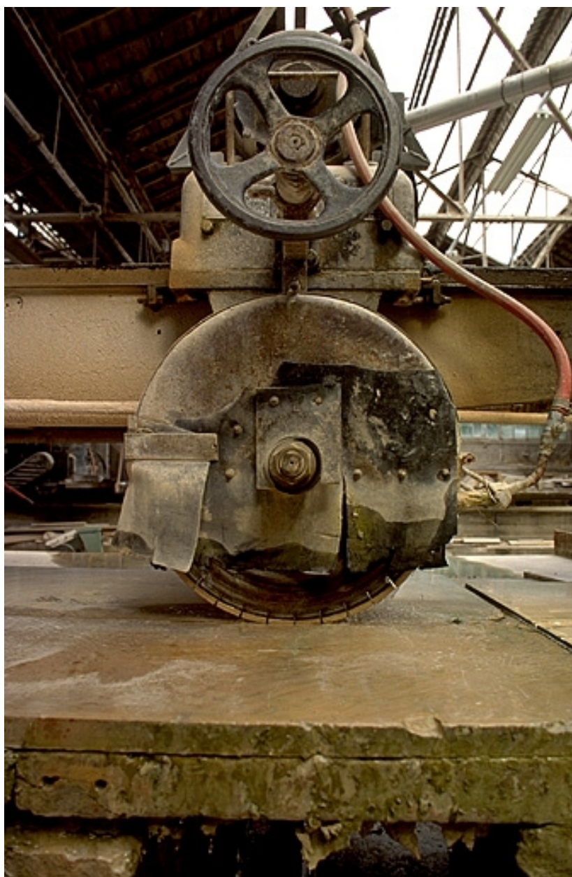
Débiteuse nord : détail de l'organe de sciage.
