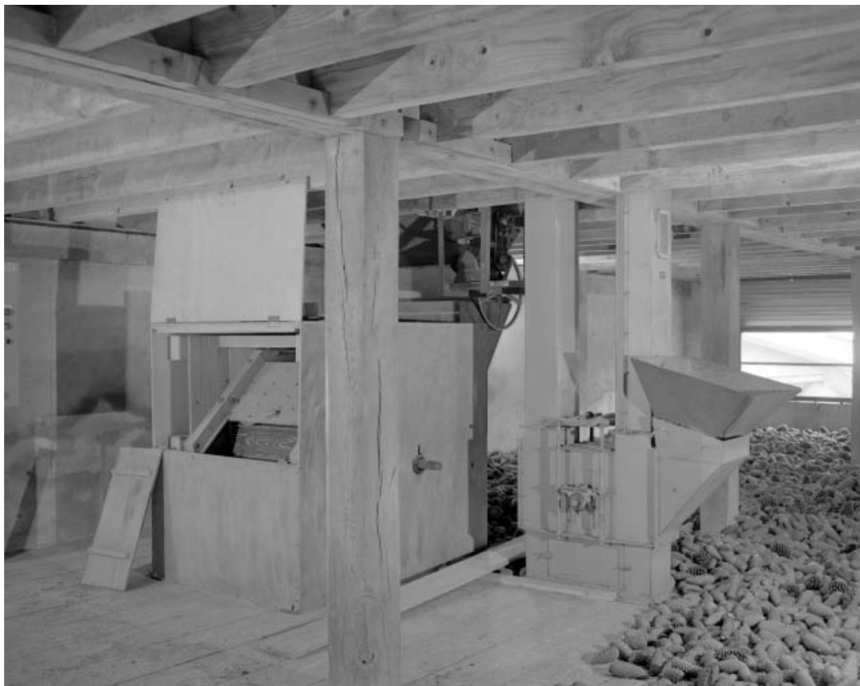
Vue d'ensemble. Bateur et élévateur à godets.
