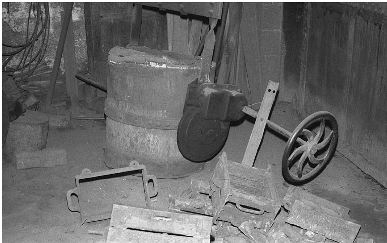
Châssis et poche de coulée.
