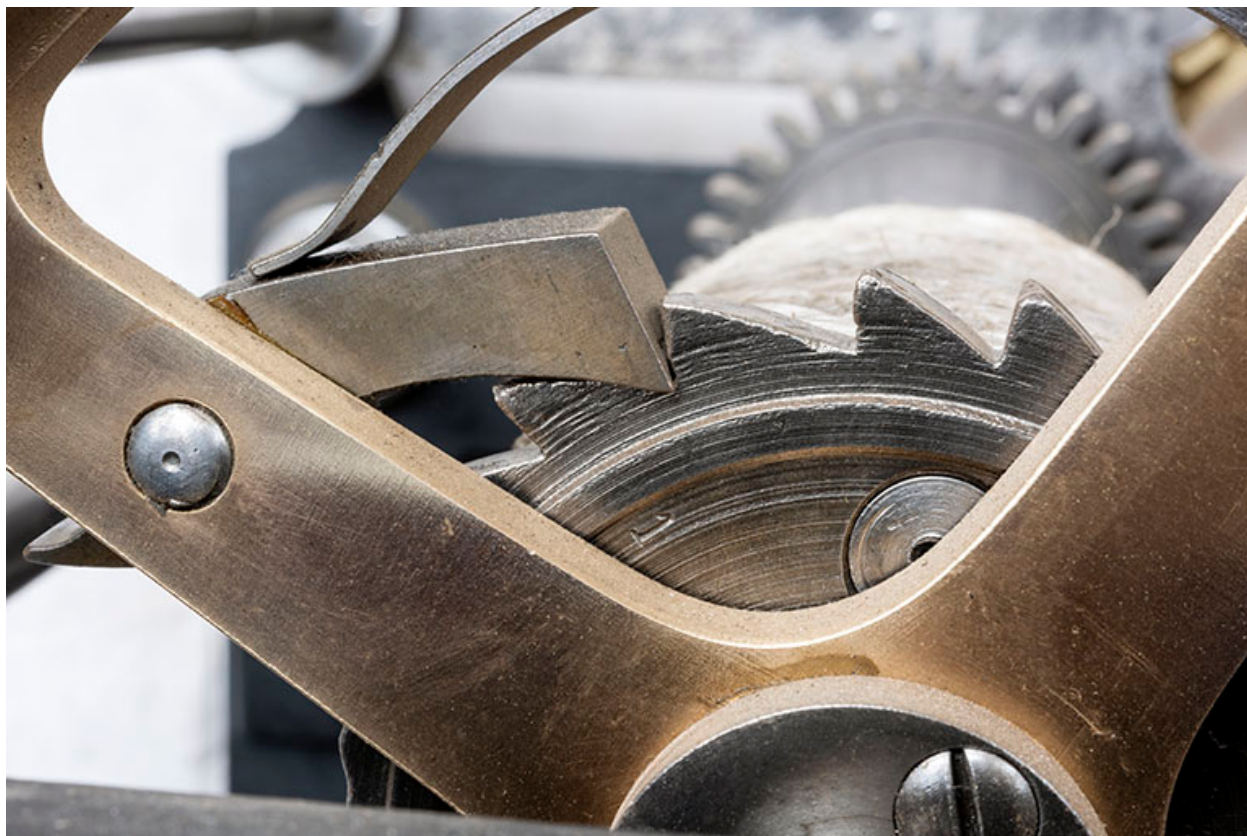
Mouvement, mécanisme des sonneries : détail du cliquet.
