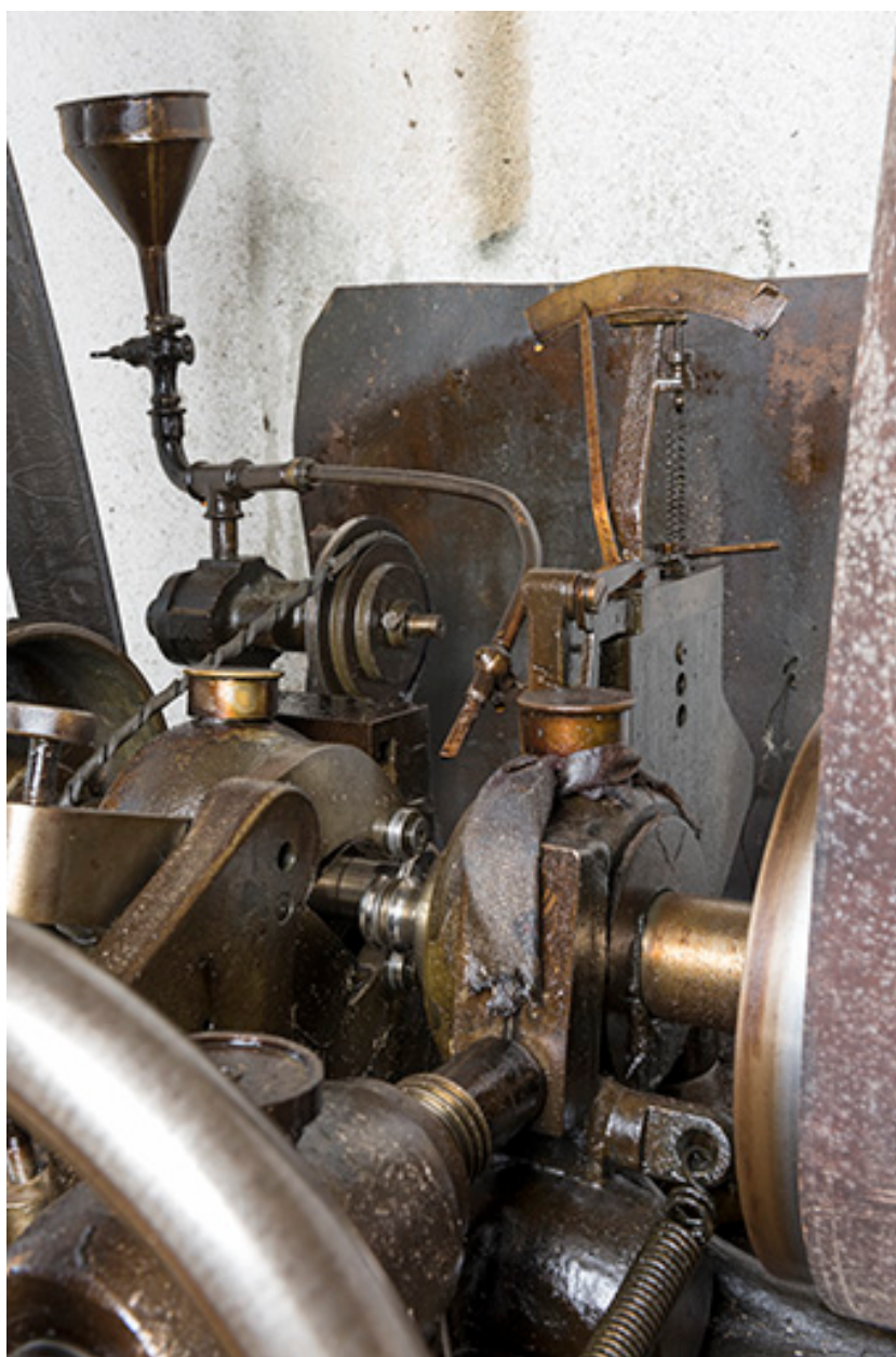
Partie travaillante (sous le tuyau d'amenée d'huile).
