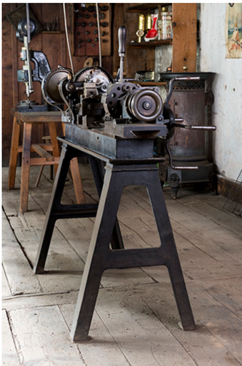
Machine sur pieds de la troisième rangée : machine à décolleter (tour revolver).
