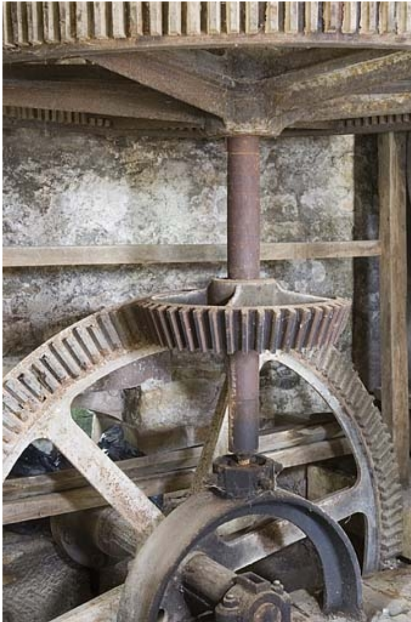
Détail des engrenages du beffroi.
