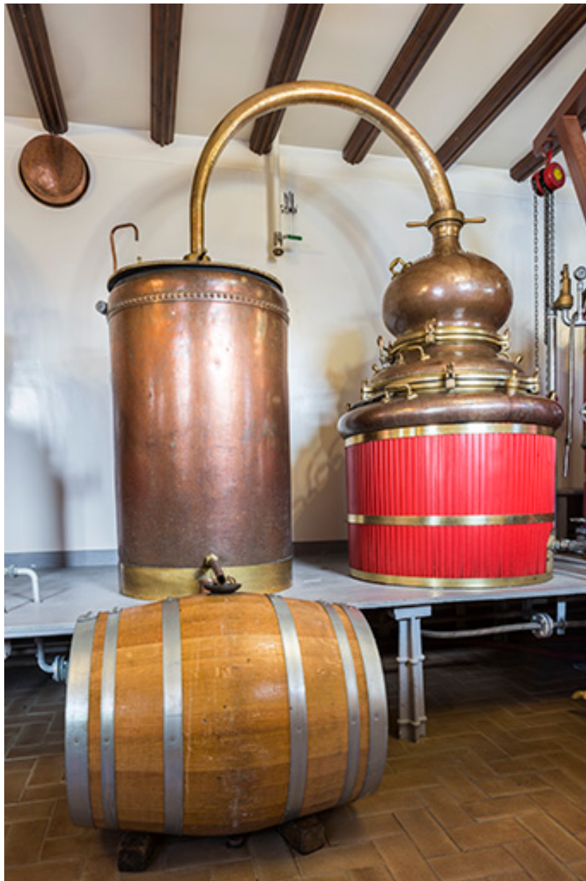
Alambic de 390 litres : cucurbite et chapiteau (à droite), col de cygne, réfrigérant (à gauche) et tonneau de réception du distillat.
