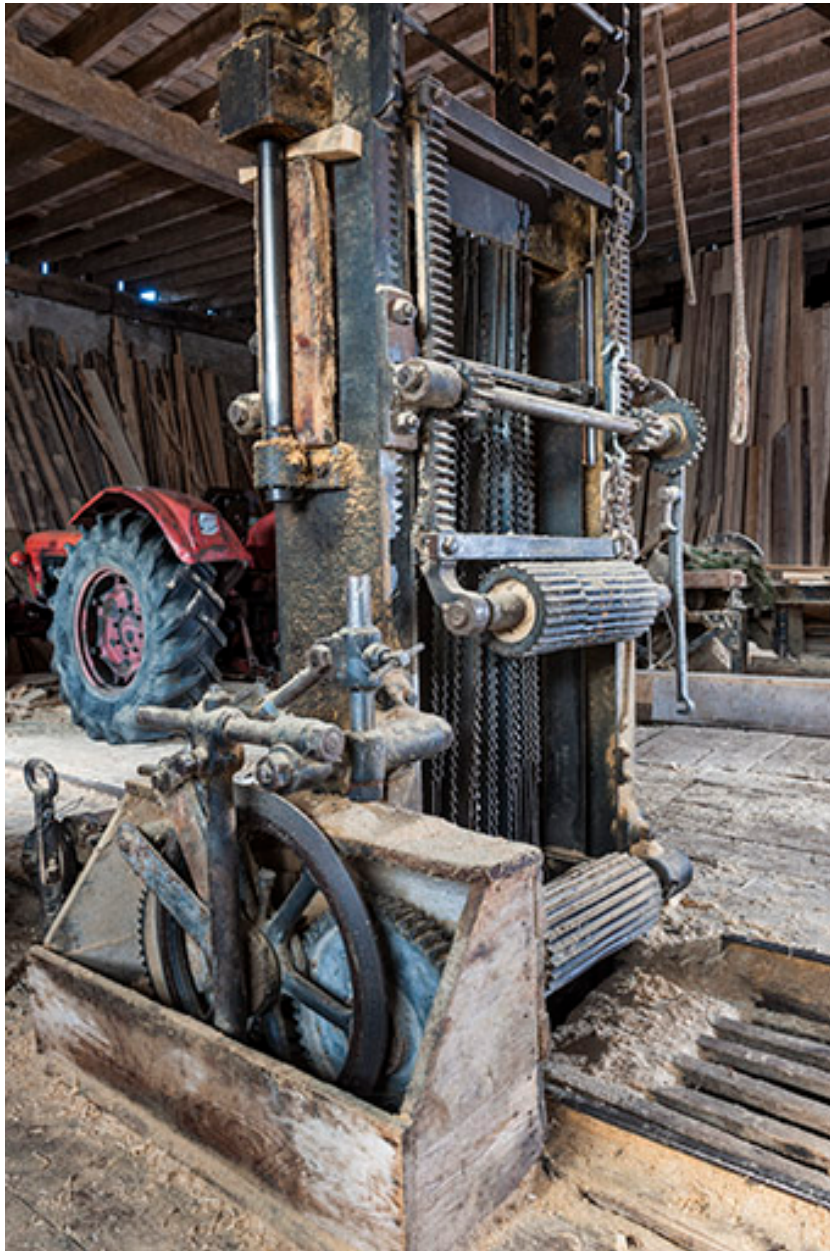
Châssis de scie vu de trois quarts. Au premier plan : système d'entraînement.
