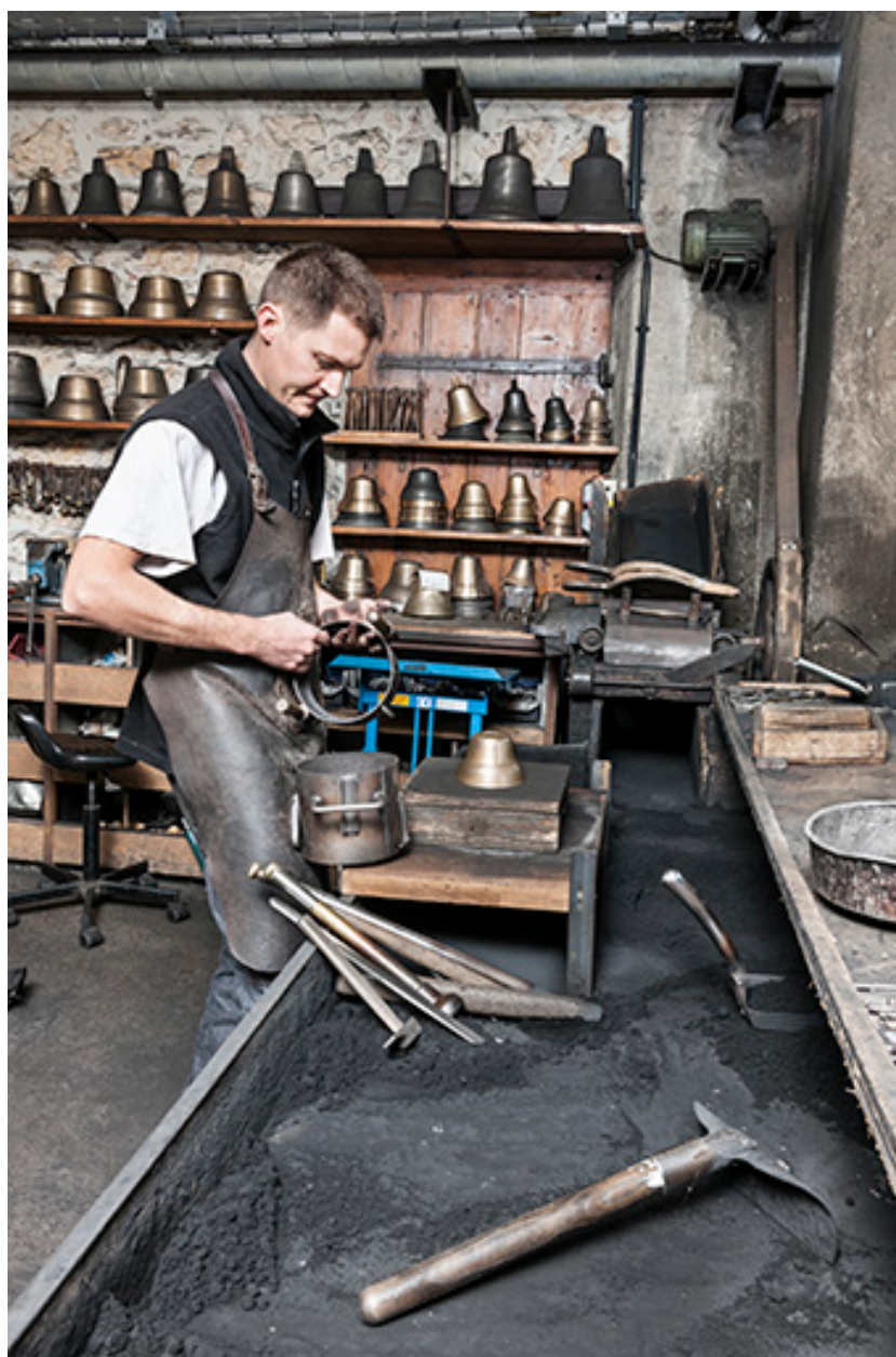
Moulage. Préparation du châssis.
