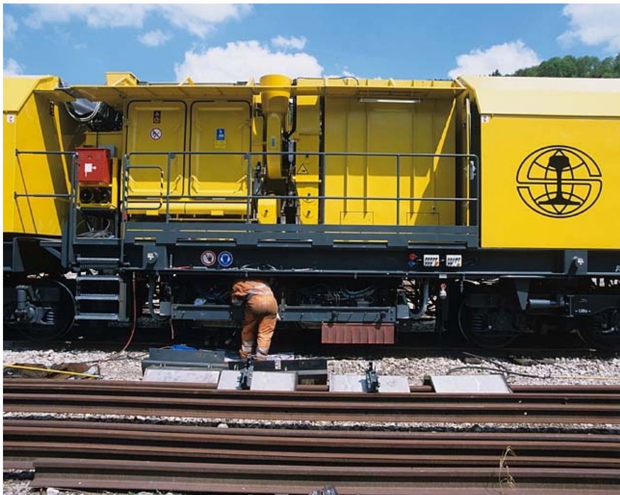
Train de meulage : maintenance et réglages sur l'un des wagons.
