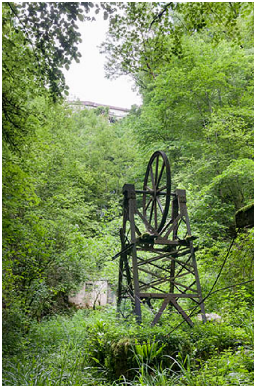
Système de transmission par câble en fond de vallée.
