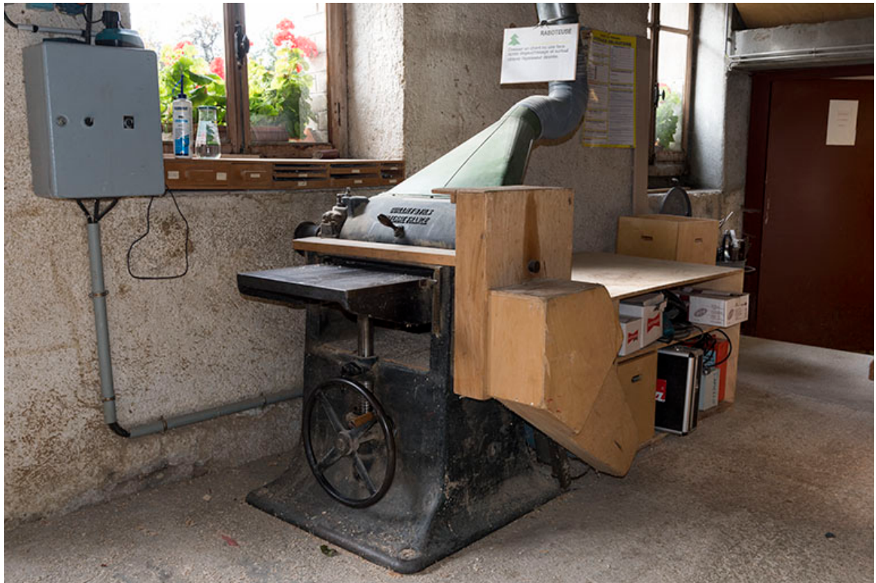
Atelier de fabrication : raboteuse Guilliet.
