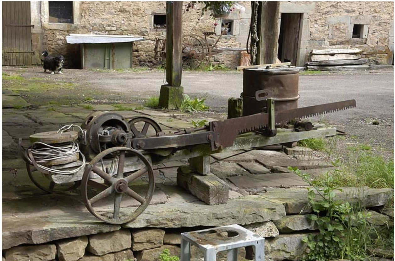
Tronçonneuse artisanale placée sous l'auvent de l'atelier.
