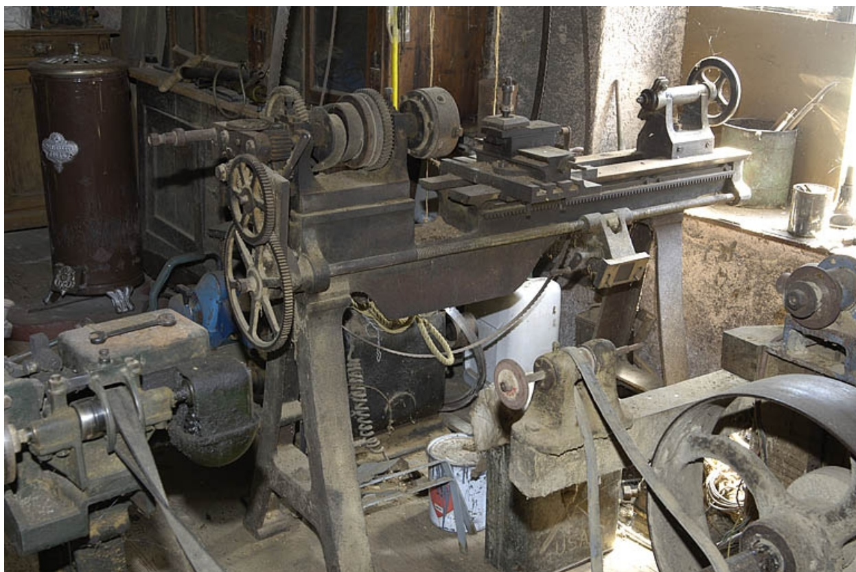
Premier étage. Tour à bois horizontal.
