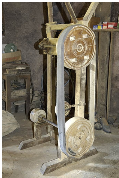
Premier étage. Polissoir à bande. Phot. Jérôme Mongreville IVR43_20057000260NUCA
