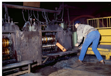
Laminage : travail en cage de dégrossis. Phot. Yves Sancey IVR43_19943900034ZA
