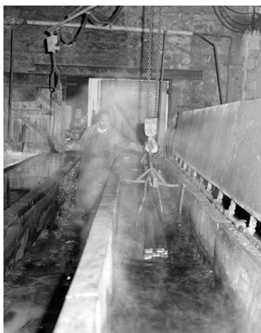
Atelier de décapage : trempage de barres dans le bain d'acide. Phot. Yves Sancey IVR43_19923900977X
