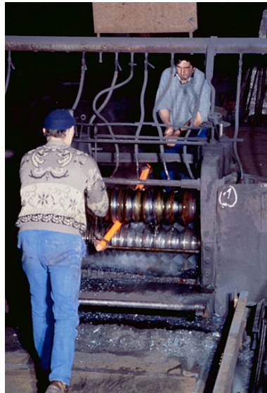
Laminage : travail en cage de dégrossis. Phot. Yves Sancey IVR43_19943900038ZA
