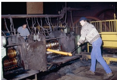
Laminage : travail en cage de dégrossis. Phot. Yves Sancey IVR43_19943900035ZA
