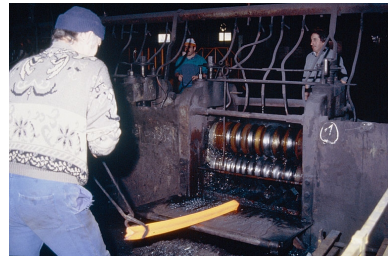
Laminage : travail en cage de dégrossis. Phot. Yves Sancey IVR43_19943900036ZA
