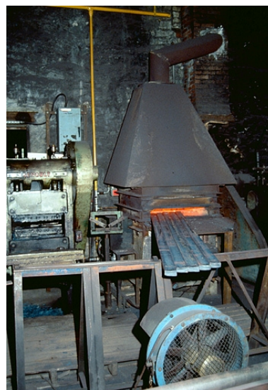
Atelier de pose des soies : chauffage des barres. Phot. Laurent Poupard IVR43_19923900981ZA
