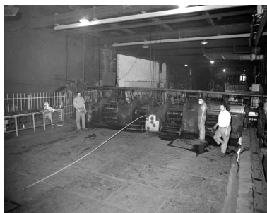
Laminoir : passage de la barre d'acier en cage de carré. Phot. Yves Sancey IVR43_19923900970X
