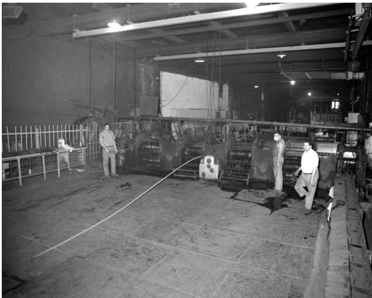
Laminage : passage de la barre d'acier en cage de carré.
