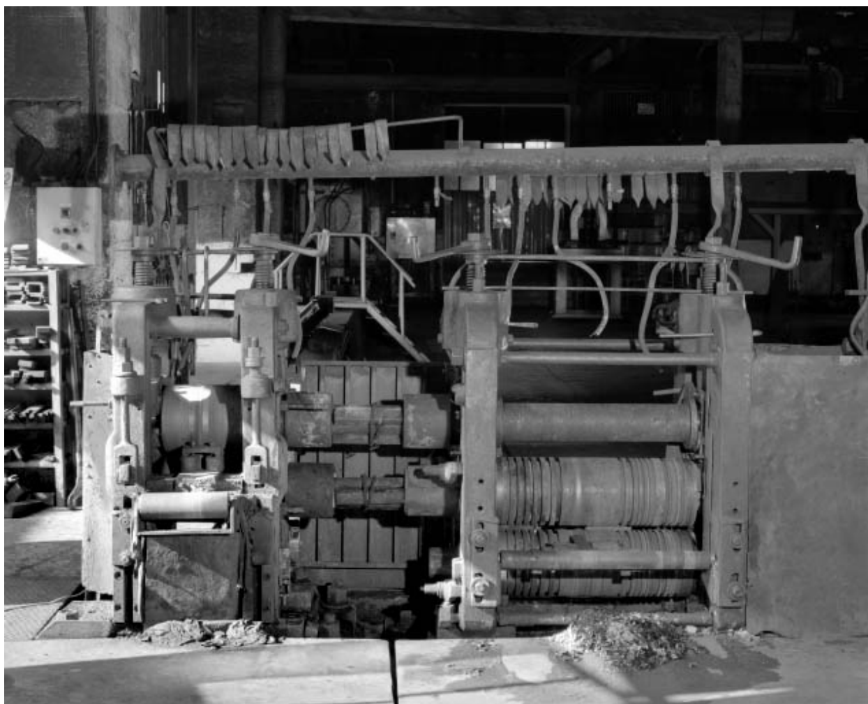
Cages du laminoir : finissage et refouloir.
