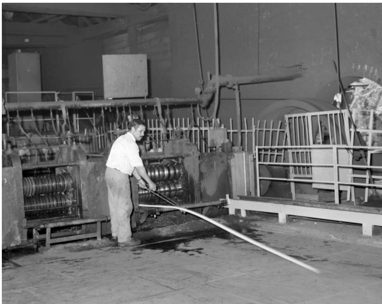
Laminoir : réception de la barre d'acier en cage de dégrossis.
