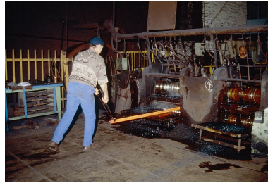
Laminage : travail en cage de dégrossis. Phot. Yves Sancey IVR43_19943900055ZA
