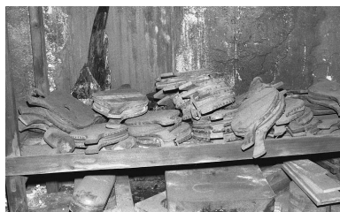
Soufflets de mouleurs (nettoyage des moules). Phot. Rémi Hamelin IVR43_20107000032NUC2A
