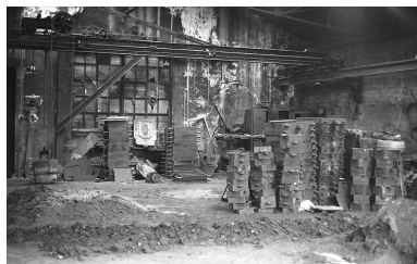
Atelier de fabrication. Châssis entreposés devant la grande étuve (à gauche). Phot. Rémi Hamelin IVR43_20107000019NUC2A
