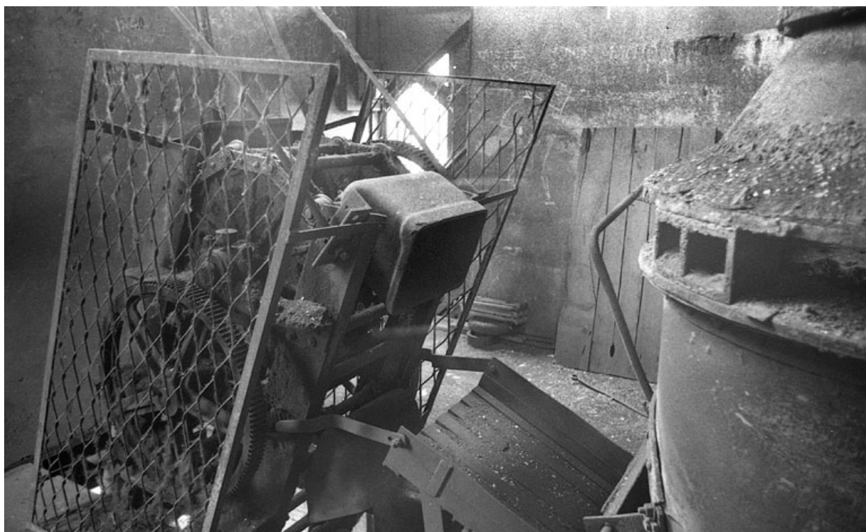
Partie supérieure du chargeur à godets et du grand cubilot (5 tonnes).
