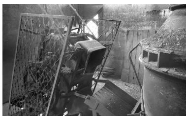
Partie supérieure du chargeur à godets et du grand cubilot (5 tonnes). Phot. Rémi Hamelin IVR43_20107000026NUC2A
