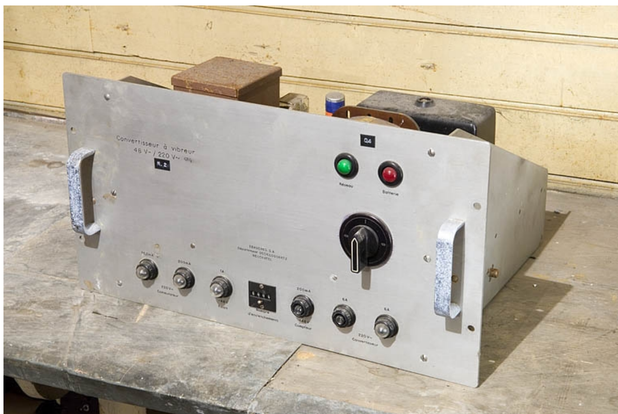
Convertisseur à vibreur équipant autrefois la station de secours (5e armoire).
