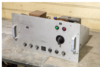
Convertisseur à vibreur équipant autrefois la station de secours (5e armoire). Phot. Jérôme Mongreville IVR43_20072501069NUCA
