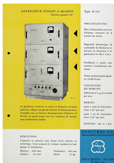
[Exemple d'appareil du département Oscilloquartz, Ebauches SA :] Générateur étalon à quartz type B-239, vers 1955. Phot. Yves Sancey IVR43_20072500655NUCA
