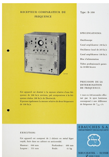
[Exemple d'appareil du département Oscilloquartz, Ebauches SA :] Récepteur-comparateur de fréquence type B-390, vers 1955. Phot. Yves Sancey IVR43_20072500658NUCA
