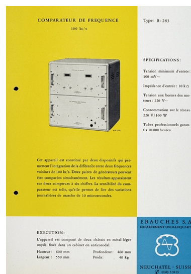
[Exemple d'appareil du département Oscilloquartz, Ebauches SA :] Comparateur de fréquence type B-283, vers 1955. Phot. Yves Sancey IVR43_20072500657NUCA
