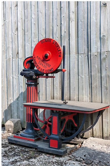
Scie à ruban Perrin (Paris), déposée. Phot. Jérôme Mongreville IVR43_20152500421NUC4A
