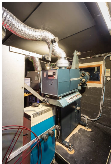
Salle 1 : cabine de projection. Projecteur 35 mm Zenith de la société milanaise Cinemeccanica au premier plan, projecteur numérique NEC à l'arrière-plan. Phot. Pierre-Marie Barbe-Richaud IVR26_20212100106NUC4A
