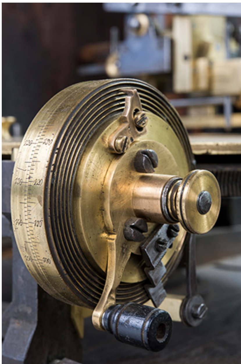
Plateau diviseur : manette et disques gradués du système de mise en rotation.
