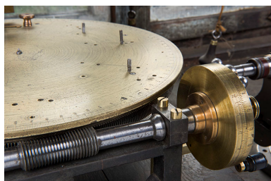
Plateau diviseur : système de mise en rotation.
