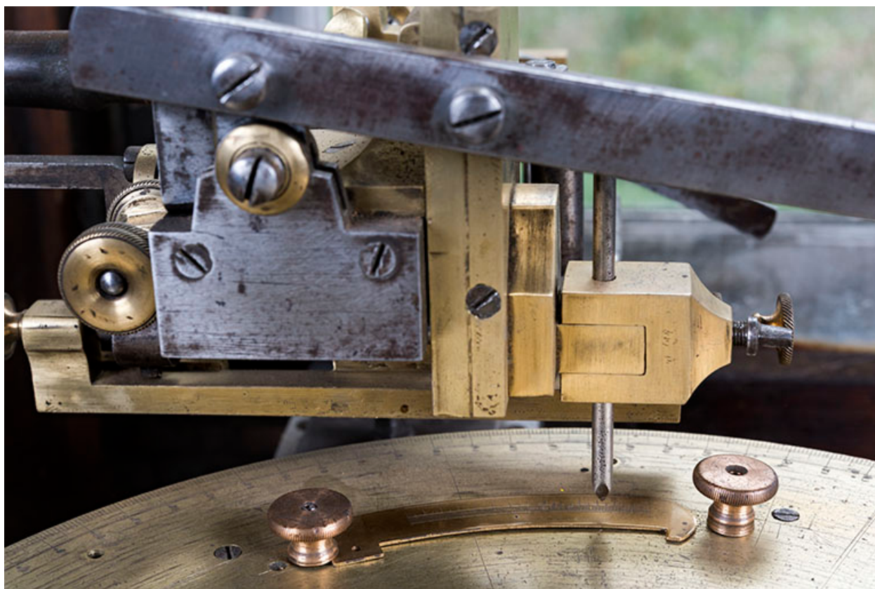
Module de gravage : détail de la pointe à graver.
