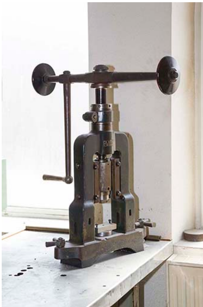
Usine, rez-de-chaussée : petite presse à balancier.
