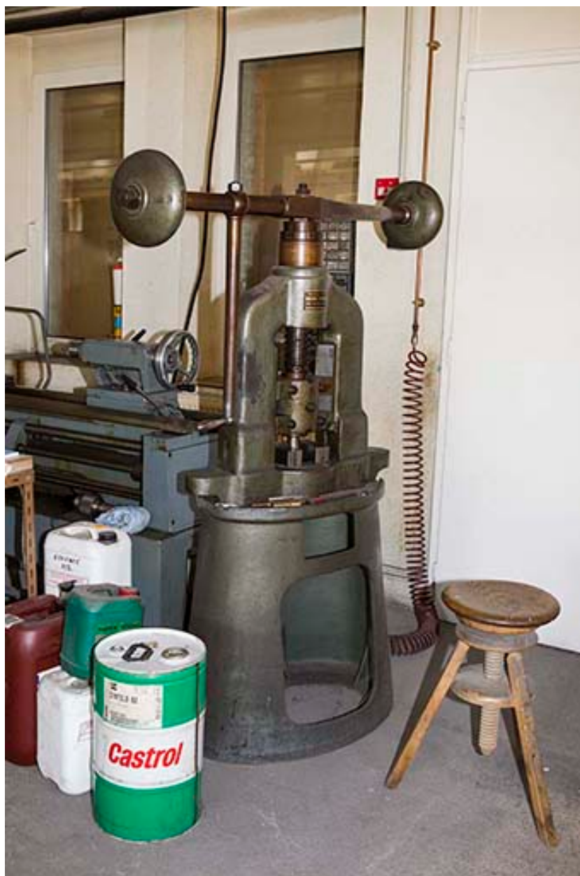
Usine, rez-de-chaussée : grosse presse à balancier.
