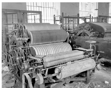
Face arrière vue de trois quarts gauche. Rouleau en bois, guide-fils, manchons frotteurs, cylindre volant et cylindres travailleurs. Phot. Yves Sancey IVR43_19943901532X
