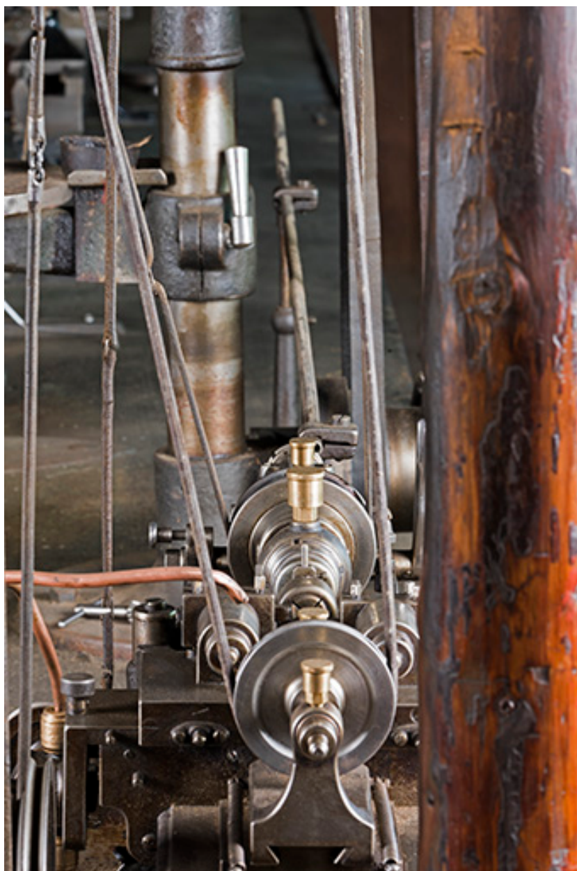
Vue de profil : poulie de l'outil au premier plan, du système d'entrainement au second plan.
