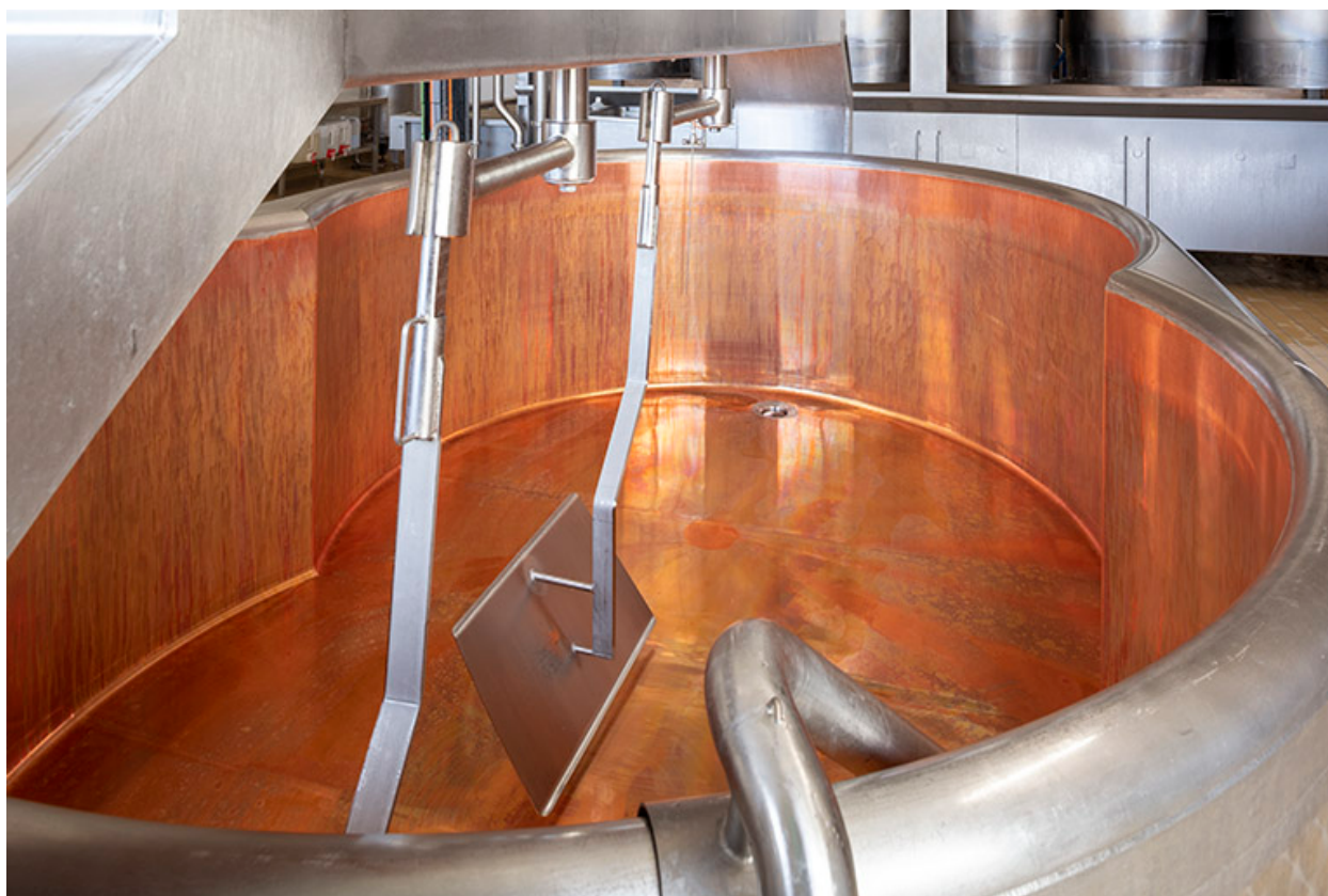
Atelier de fabrication : intérieur d'une cuve.
