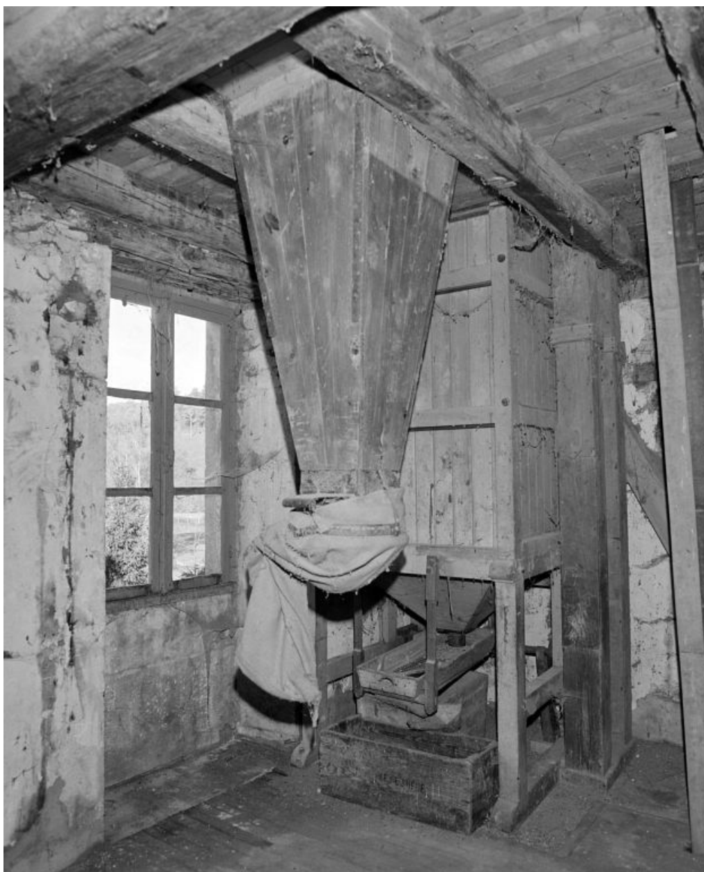
1er étage. Boisseau à farine et ensacheur.
