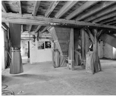
1er étage. Ensacheurs. Phot. Jean-Luc Duthu IVR26_20062106702X
