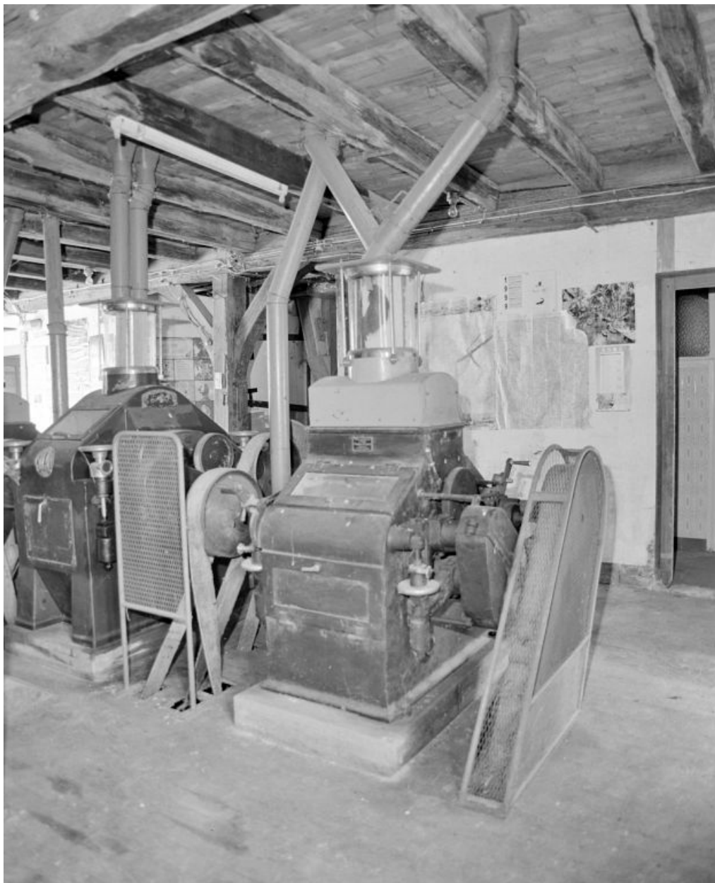
Rez-de-chaussée. Broyeurs (Ateliers de construction Camus frères, ingénieurs, Tonnerre et Socam, Paris), détail.
