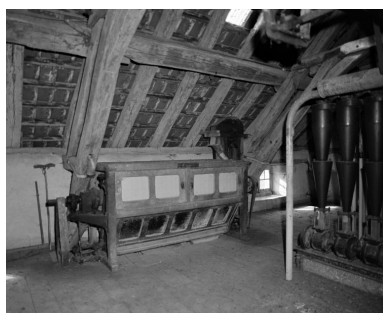
Comble à surcroît. Ecluses et trieur à son (anciens établissements G. et A. Cusson et Cie, Châteauroux). Phot. Jean-Luc Duthu IVR26_20062106748X
