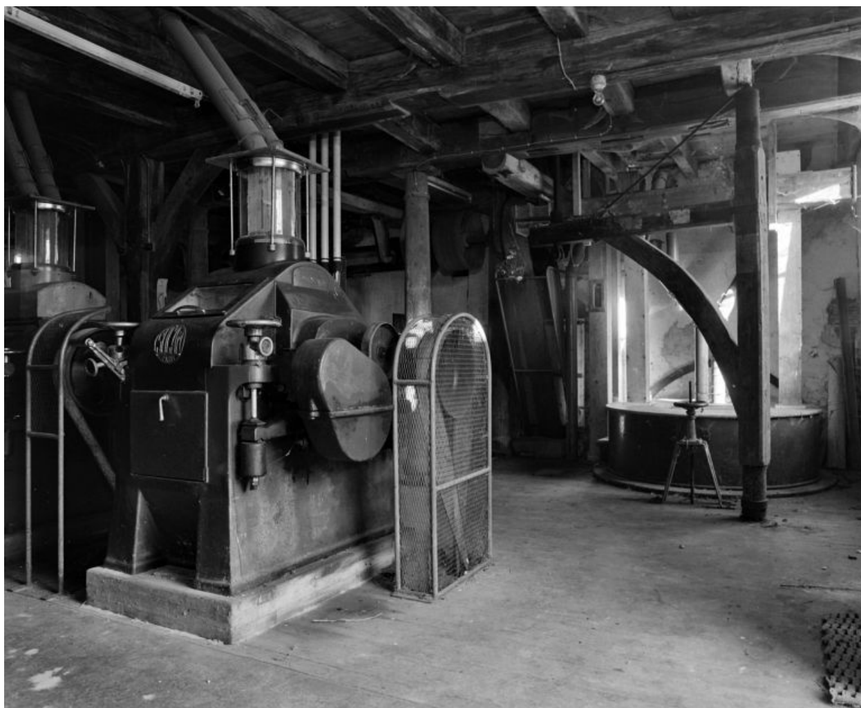
Rez-de-chaussée. Broyeur (marque Socam, Paris).
