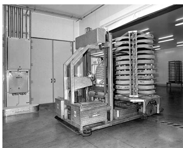
Transport des meules sur chariot électrique. Phot. Yves Sancey IVR43_19963901926X
