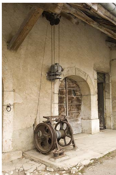
Déchargeuse : vue d'ensemble du treuil.
