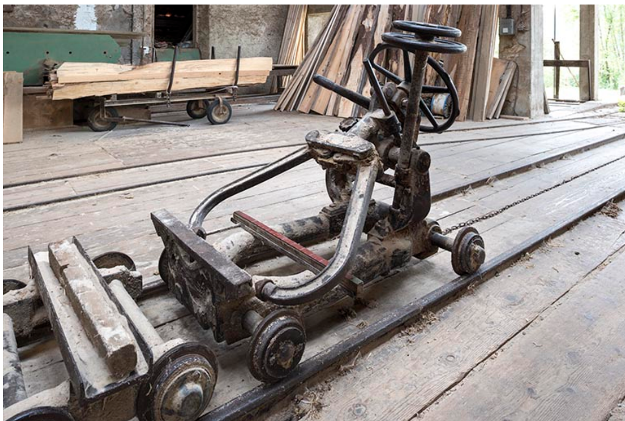
Atelier de fabrication : châssis de scie Socolest, chariot d'entraînement.
