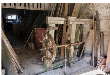
Bâtiment ancien, partie gauche (bâtiment d'eau) : commande de la vanne d'admission d'eau. Phot. Sonia Dourlot IVR43_20172501672NUC4A
