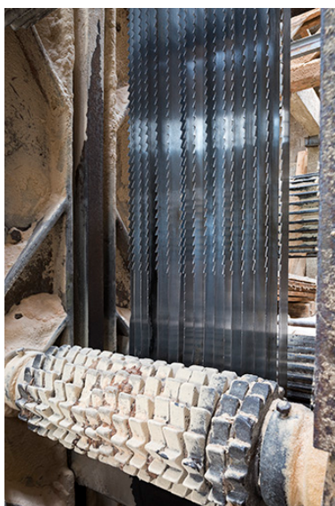
Atelier de fabrication : châssis de scie Socolest, rouleau et lames. Phot. Sonia Dourlot IVR43_20172501687NUC4A
