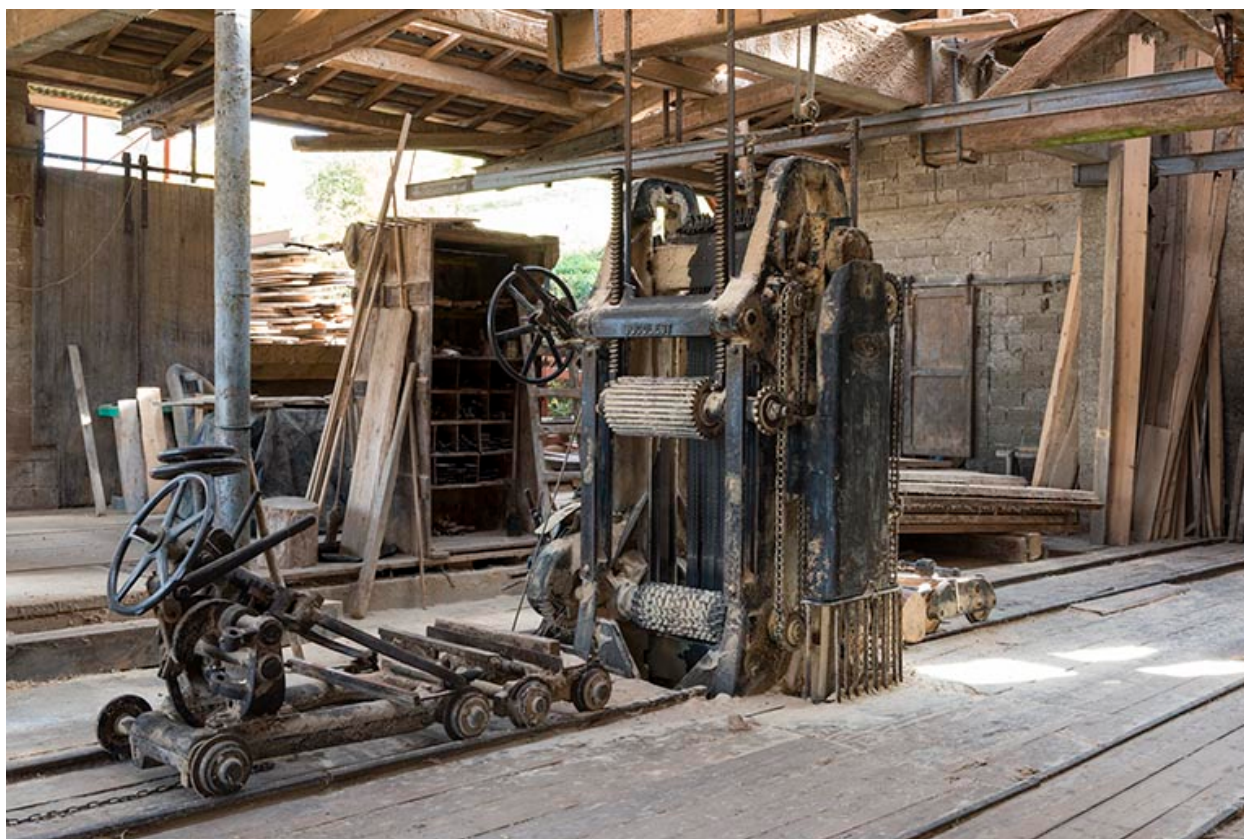
Atelier de fabrication : châssis de scie Socolest, vu de trois quarts droite.
