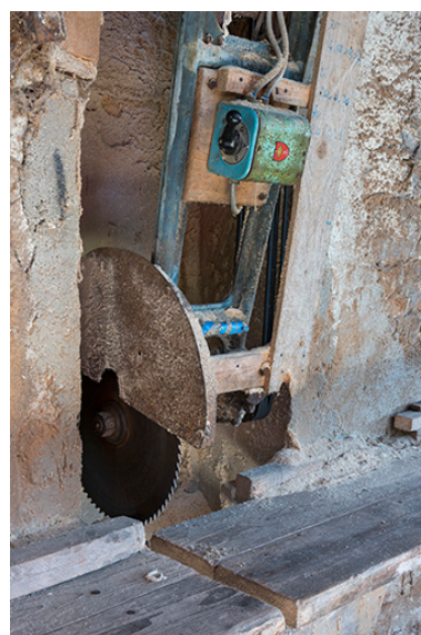
Atelier de fabrication : détail de la scie circulaire à balancier Guillet et Fils. Phot. Sonia Dourlot IVR43_20172501691NUC4A
