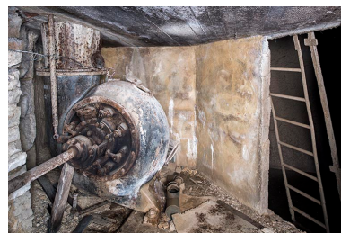
Atelier de fabrication, sciurier : turbine Douge. La chambre d'eau est à gauche. Phot. Sonia Dourlot IVR43_20172501699NUC4A
