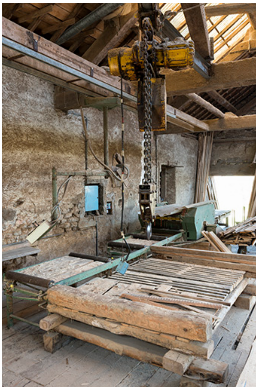
Atelier de fabrication : palan et déligneuse Esterer.
