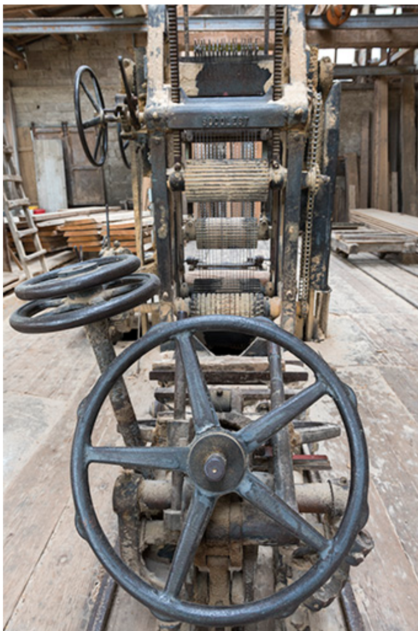
Atelier de fabrication : châssis de scie Socolest, volant sur le chariot d'entraînement.
