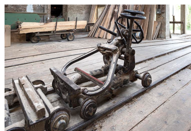
Atelier de fabrication : châssis de scie Socolest, chariot d'entraînement. Phot. Sonia Dourlot IVR43_20172501688NUC4A
