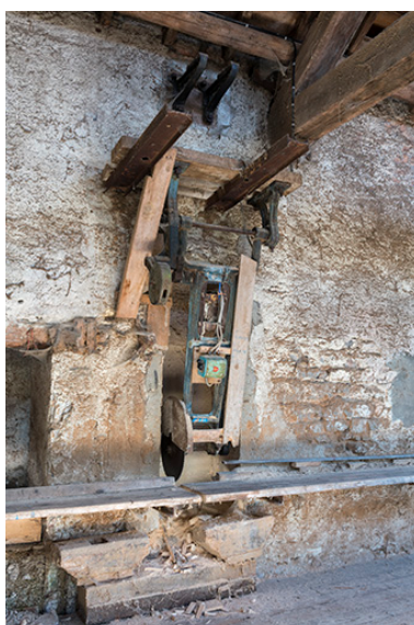
Atelier de fabrication : scie circulaire à balancier Guillet et Fils. Phot. Sonia Dourlot IVR43_20172501690NUC4A
