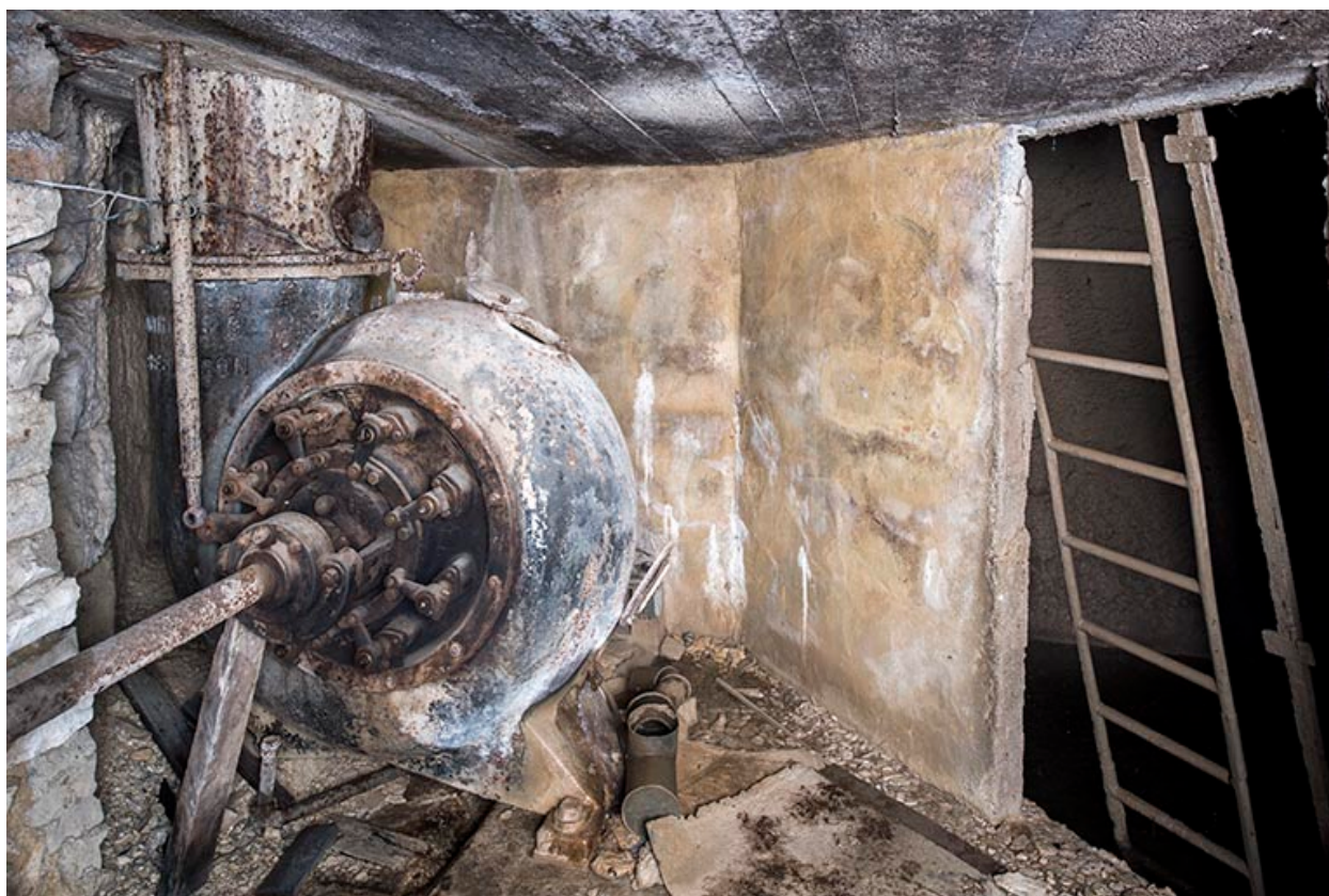
Atelier de fabrication, sciurier : turbine Douge. La chambre d'eau est à gauche.
