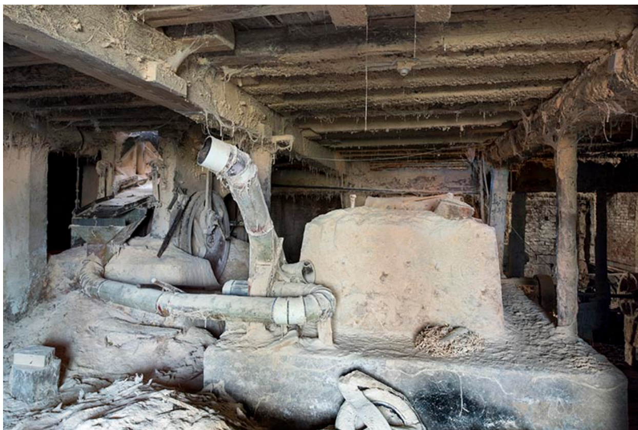
Atelier de fabrication, sciurier : massifs en maçonnerie de la scie Socolest (à gauche) et d'un châssis démonté.
