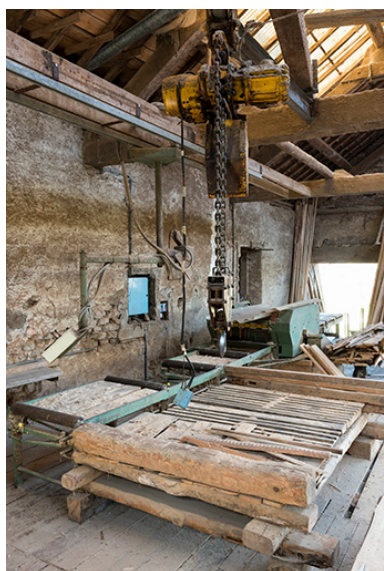
Atelier de fabrication : palan et déligneuse Esterer. Phot. Sonia Dourlot IVR43_20172501692NUC4A
