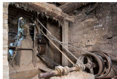
Atelier de fabrication, sciurier : transmission (poules et courroies) du châssis Socolest. Phot. Sonia Dourlot IVR43_20172501702NUC4A
