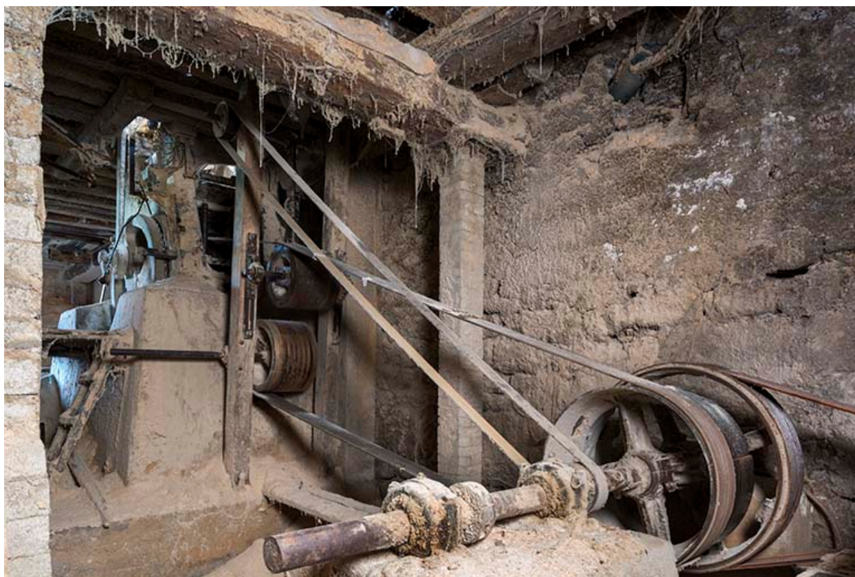
Atelier de fabrication, sciurier : transmission (poulies et courroies) du châssis Socolest.
