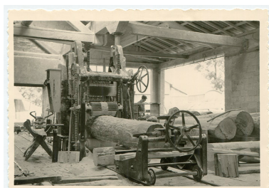
[Sciage au gros châssis de scie Socolest, vu depuis le fond de l'atelier], années 1960. Autr. auteur inconnu IVR43_20172501520NUC4A
