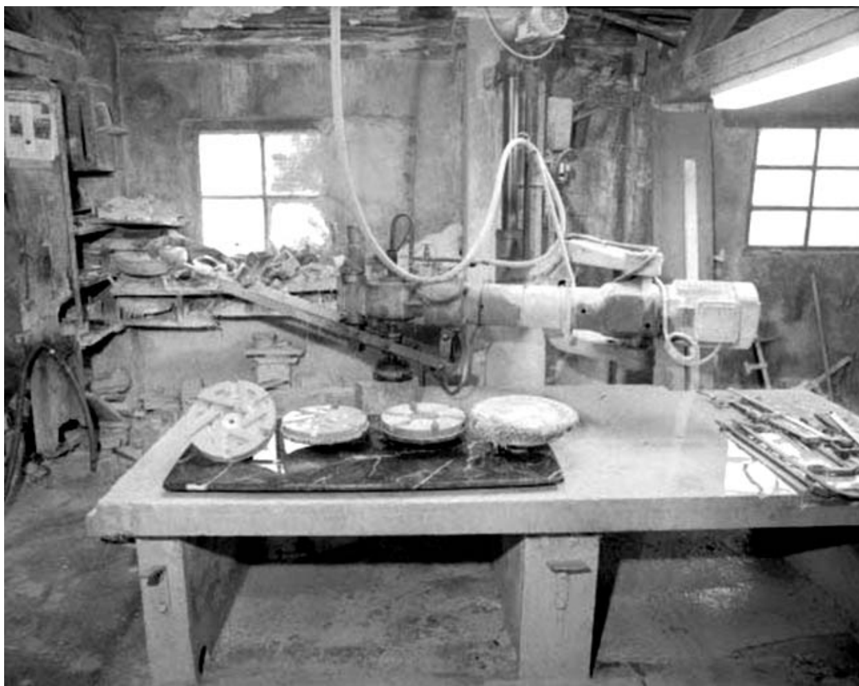
Polissoir à genouillère et ses plateaux. Plateaux à revêtement en carborandum, en acide oxalyque et en cordes.
