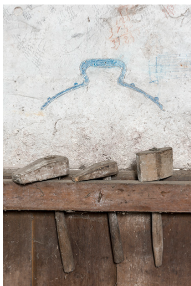
Atelier de fabrication : maillets de dinandier et dessin de couvercle. Phot. Sonia Dourlot IVR43_20172501722NUC4A
