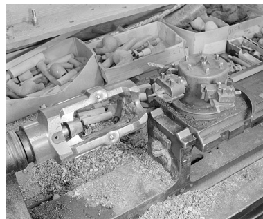
Tour (atelier de finissage). Les mâchoires et le revolver alignés. Phot. Jérôme Mongreville IVR43_20022500476X
