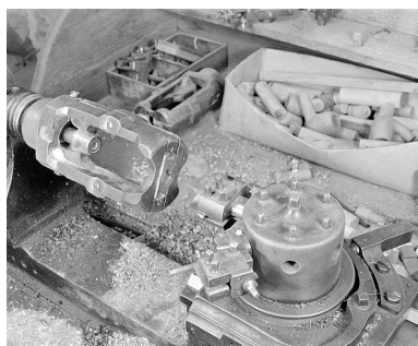
Tour (atelier de finissage). Les mâchoires et le revolver alignés, vus de trois quarts droite. Phot. Jérôme Mongreville IVR43_20022500477X
