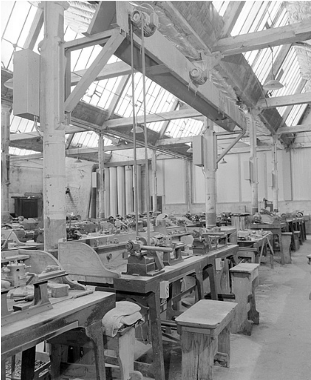
Vue d'ensemble de deux tours de l'atelier principal (avec le moteur du tour central).
