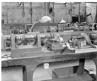
Déplacement de la troisième main vers la gauche : la mèche perce la tige (atelier principal). Phot. Jérôme Mongreville IVR43_20022500637X
