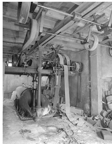
Bâtiment d'eau : bache de la turbine et transmission. Phot. Jérôme Mongreville IVR43_19913900550X
