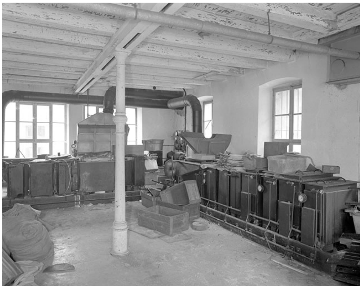
Atelier de fabrication (rez-de-chaussée) : chaîne d'électrolyse.
