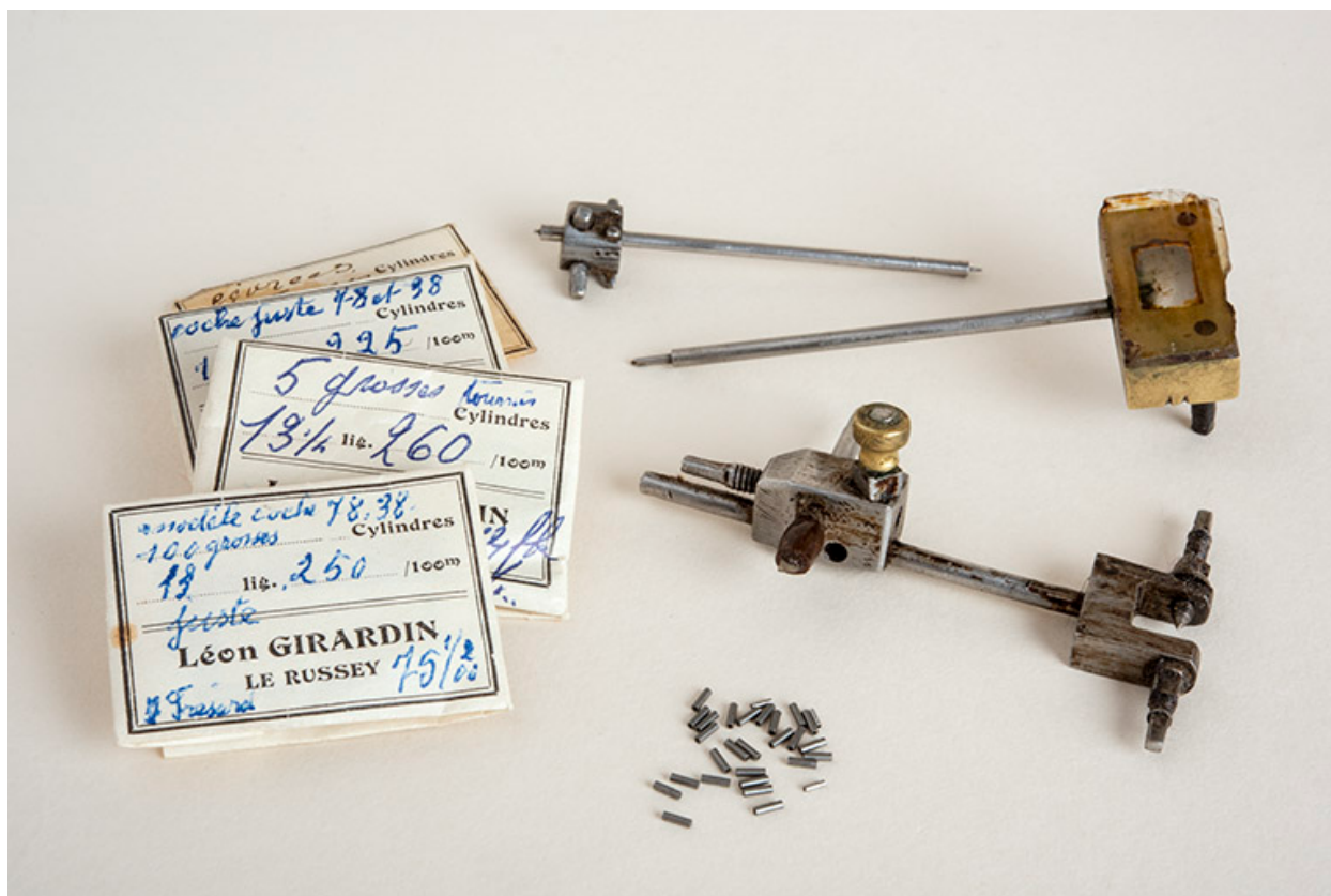
Eléments de machines et paquets de cylindres. Au premier plan au centre : cylindres non encochés.
