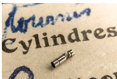
Ecorce de cylindre achevée et polie. Phot. Sonia Dourlot IVR43_20202500019NUC4A
