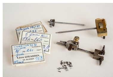
Eléments de machines et paquets de cylindres. Au premier plan au centre : cylindres non encochés. Phot. Sonia Dourlot IVR43_20192500442NUC4A
