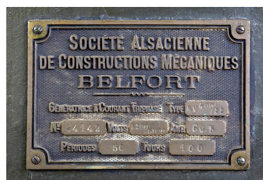
Plaque de constructeur d'un alternateur SACM. Phot. Yves Sancey IVR43_20122502061NUC2A
