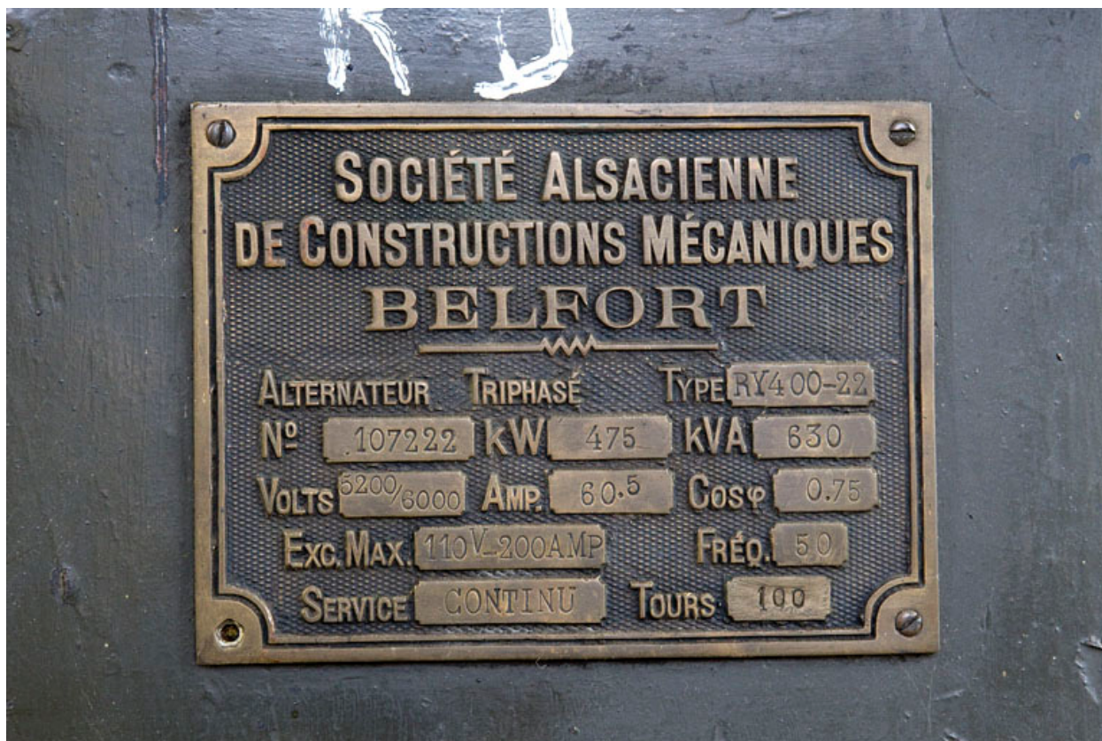
Plaque de constructeur d'un alternateur SACM.
