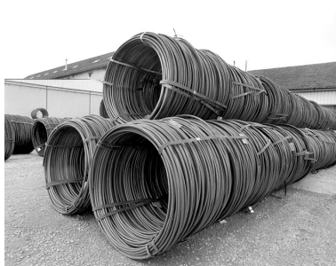
Bobines de fil d'acier destinées à la fabrication de boulonnerie. Phot. Yves Sancey IVR43_20009000709X
