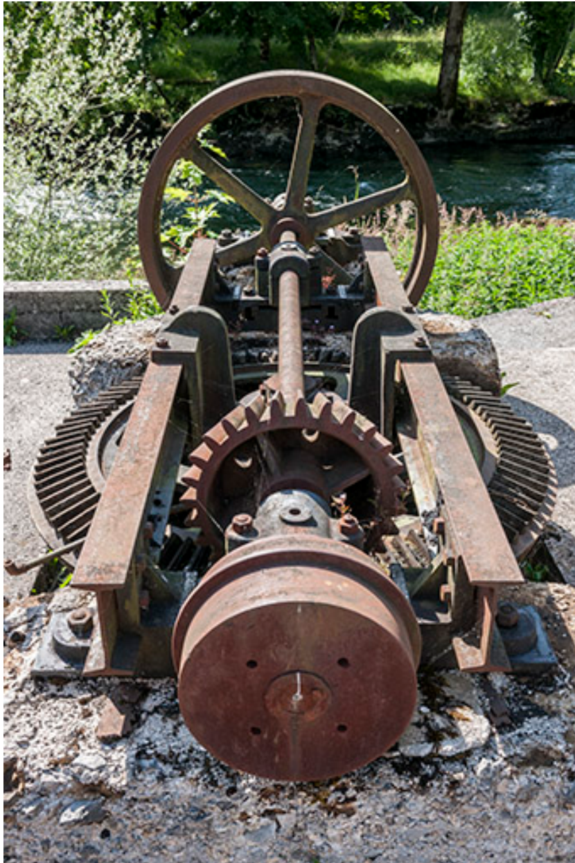
Départ de la transmission de la turbine.
