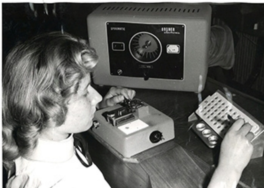
BATTERIE DE 5 APPAREILS CHRONOGRAPHIC SUPER GRAINER APPAREIL DE CONTRÔLE D'AMPLITUDE
