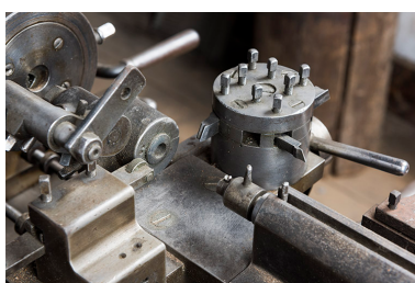
Détail de la partie travaillante : poupée avec passage de la barre (à gauche), tourelle revolver (au centre) et porte-outil d'extrémité (à droite). Phot. Sonia Dourlot IVR43_20172500079NUC4A
