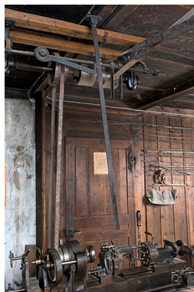
Système de transmission au plafond. Phot. Sonia Dourlot IVR43_20172500077NUC4A
