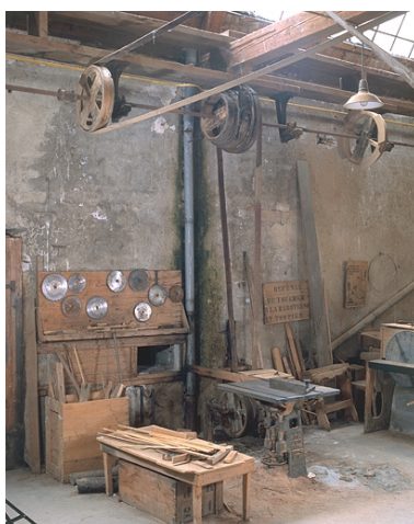
Vue d'ensemble avec le système de transmission. Phot. Yves Sancey IVR43_20022500752XA
