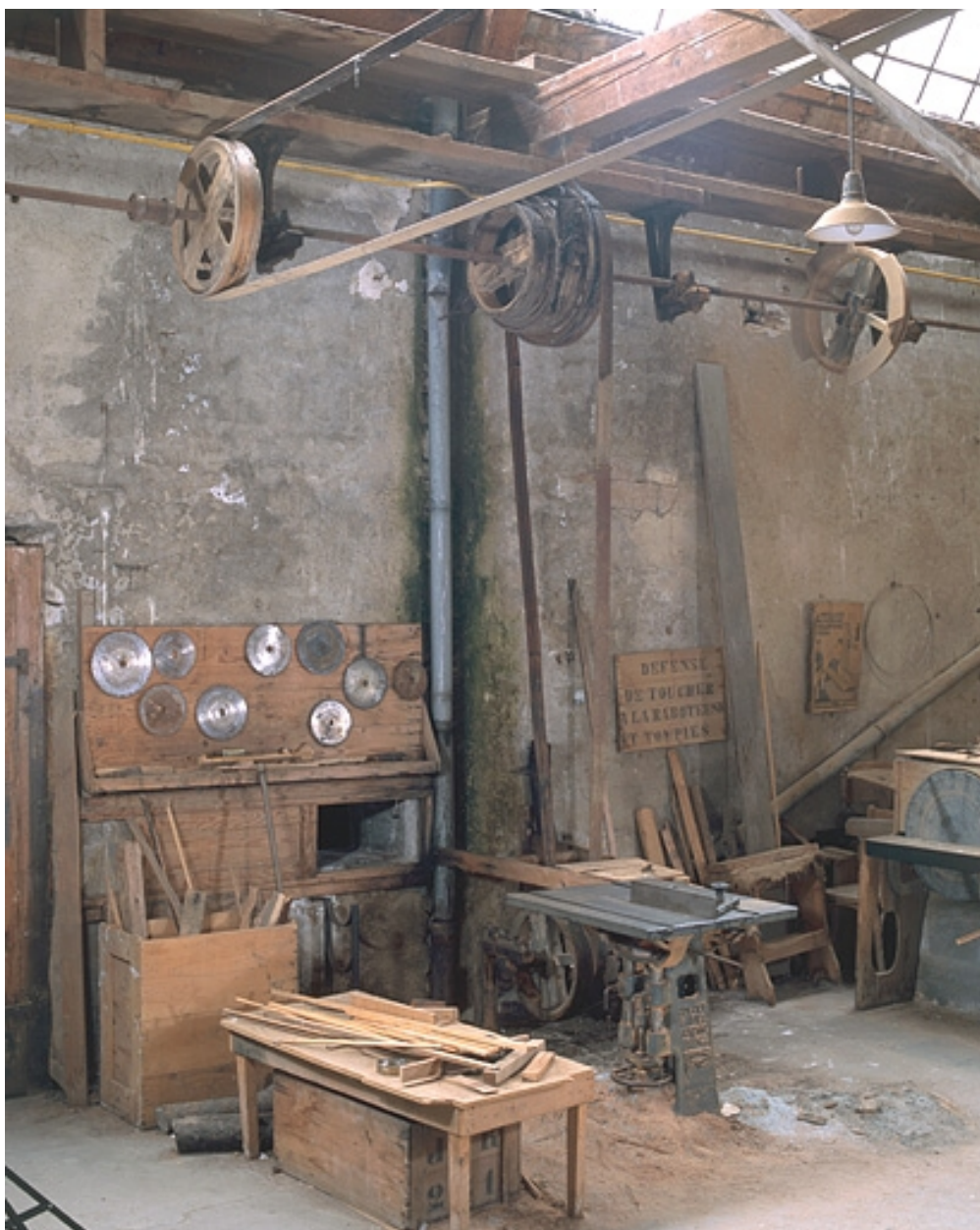
Vue d'ensemble avec le système de transmission.
